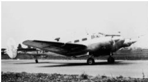
Beechcraft P-18 construit par la SFERMA et motorisé par deux Turboméca « Bastan » (1958).
