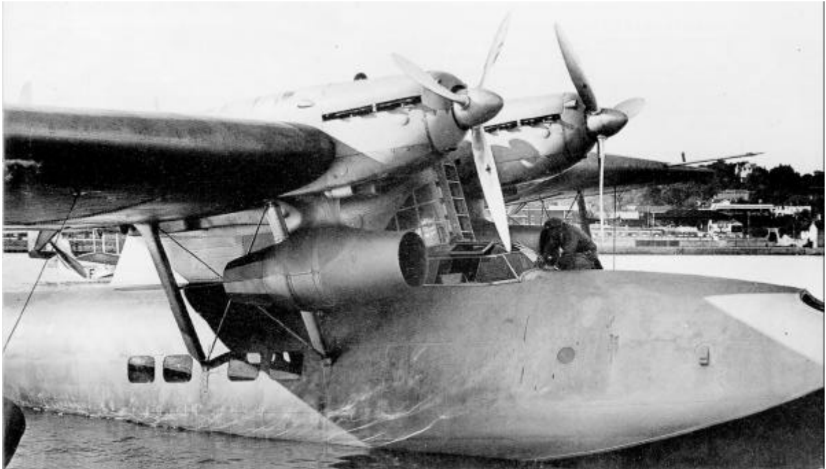
Prototype de l'hydravion de transport Lioré et Olivier H-47 aux essais à Antibes (1936). On distingue les fameux radiateurs aérodynamiques Mercier sous les fuseaux moteurs. (Cliché Musée de l'Air).
