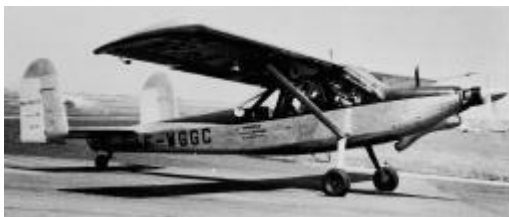
Max Holste MH 153 « Super Broussard » à turbine Turboméca « Astazou » (1959).
